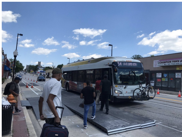
Hier ein Beispiel für eine Protected Bike Lane mit Haltestellenkap aus den USA. © Ryan Dorsey
