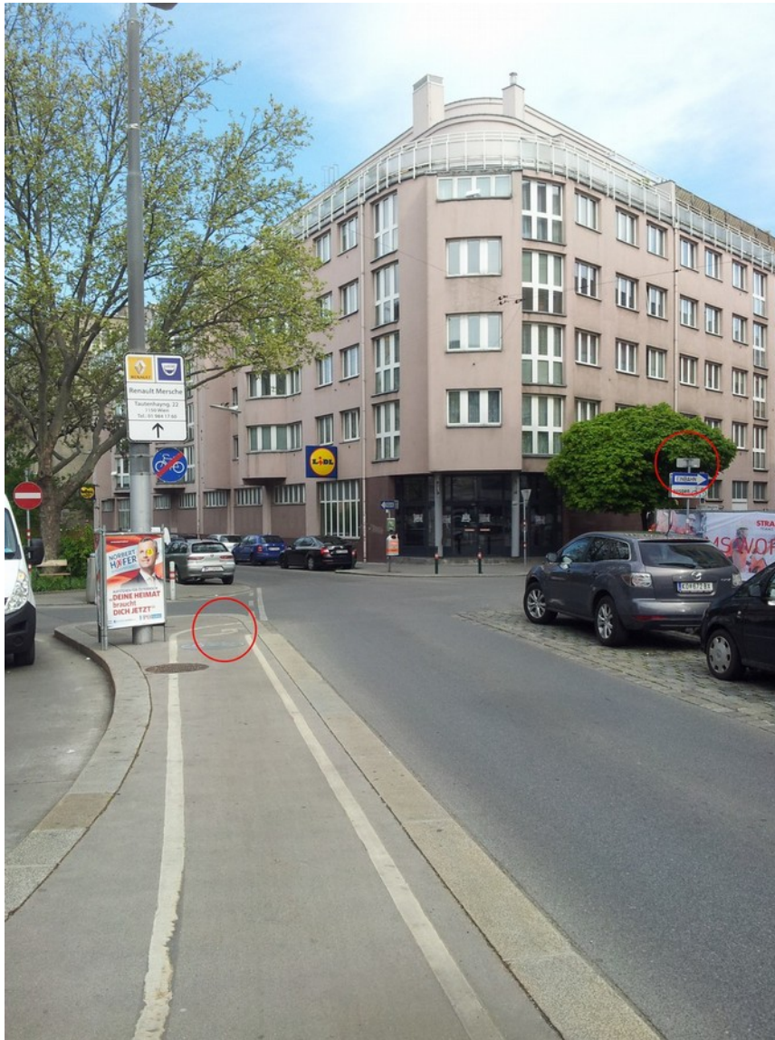
Abbildung 4: Foto vom Einrichtungsradweg in Richtung der Radroute. Die Sperrlinie (siehe Punkt 1.1) ist hier auch sichtbar, oberhalb vom linken roten Kreis. Der rote Kreis links markiert den Linksabbiegen-Pfeil auf die Schanzstraße (siehe Punkt 1.3). Der rote Kreis rechts markiert den Wegweiser Richtung Schmelz - der nur von der anderen Seite zu lesen ist (siehe Punkt 1.4).
